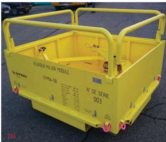
[1] Module Majeur 3 pour le moteur SAM 146. [2] Conteneur Module Majeur Gearbox pour le moteur CFM56. [3] Conteneur HP GP 7200.
